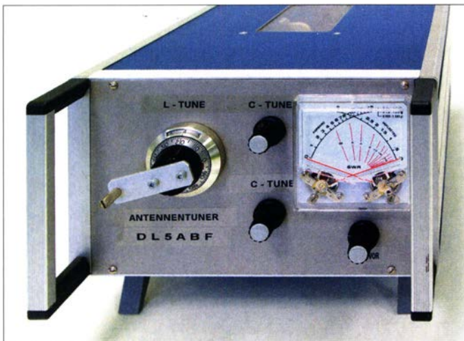
Bild 1: Kompletter Aufbau des Antennenkopplers mit Feinantrieb der Rollspule
