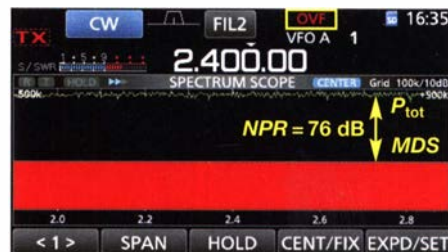
Bild 8: Alternative NPR-Bestimmung mithilfe der OVF-Anzeige, Ergebnis: NPR = 76 dB
