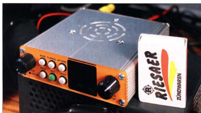
Bild 1: Transceiver Minion SDR auf einem Netzteil im Größenvergleich mit einer Streichholzschatel
