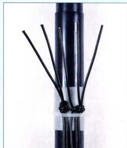
Bild 11: Befestigung von Strahler und Dachkapazität am Mast vor dem Verlöten der Drahtenden Fotos: DH0IP
