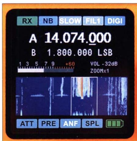
Bild 3: Darstellung eines 14 kHz breiten Bandsegments (Zoom x1) als Wasserfall während einer Digimode-Verbindung
