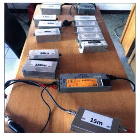
Bandpassfilter minimierten gegenseitige Störungen beim gleichzeitigen Betrieb mehrerer Transceiver.
