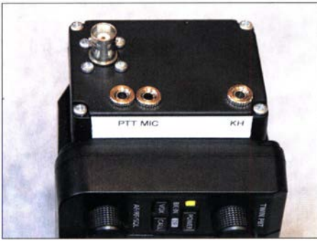
Bild 4: Schaltbox, am IC-705 fertig montiert
