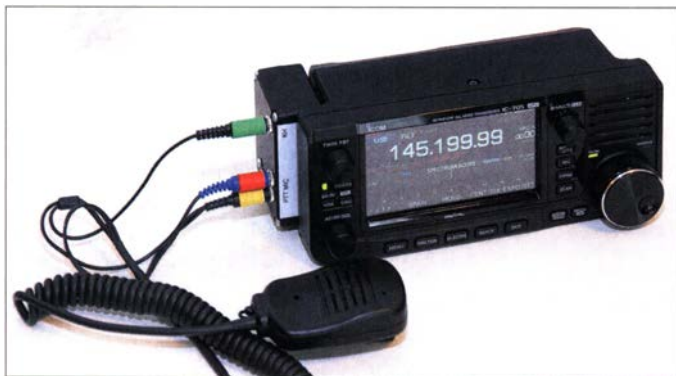
Bild 1: Seitlich am Icom IC-705 montiert, erweckt die Schaltbox den Eindruck, als ob sie von Haus aus dazugehöre.
