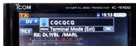
Bild 4: IC-9700 im Terminal-Mode (ext) in Verbindung mit Doozy und (int) Nutzung der LAN-Funktionalität
