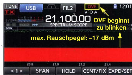
Bild 6: Aufleuchtende OVF-Anzeige bei einer Rauschleistung P_{\text{tot}} = -17 dBm und f_c = 21,1 MHz
