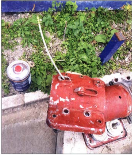
Bild 9: Seilende im Schlitz der einen Halbschale des Hauptrohrs
