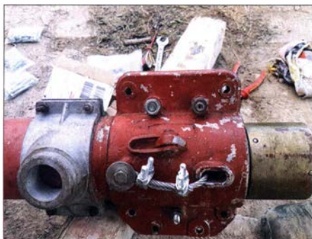
Bild 11: Befestigung des Seilendes an einer Halbschale des Hauptrohrs
