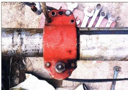
Bild 2: Zwei verschraubte Halbschalen umfassen jeweils die Übergangsstelle zwischen zwei Segmenten.
