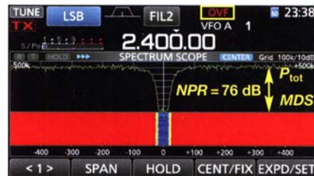
Bild 7: Displayanzeige bei der klassischen Messung mithilfe eines Notch-Filters, Ergebnis: NPR = 76 dB
