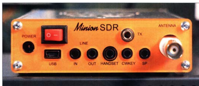
Bild 5: Frontseite des Minion SDR während einer SSB-Verbindung
