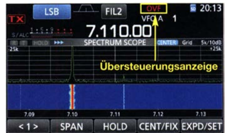
Bild 3: Overflow-Anzeige (OVF) auf dem Display des IC-7300 bei einem HF-Eintonsignal mit P_e = -8\text{ dBm}
